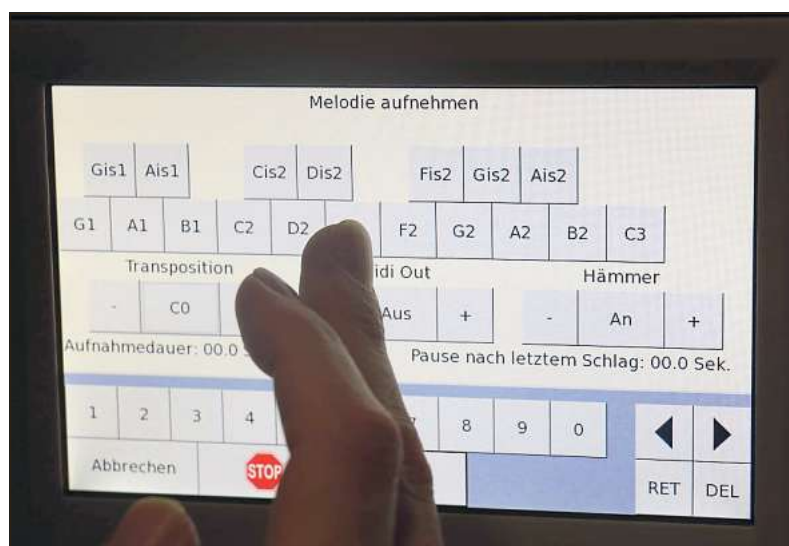
Über ein kleines Display können die Glocken zum Klingen gebracht und Melodien gespeichert werden.
